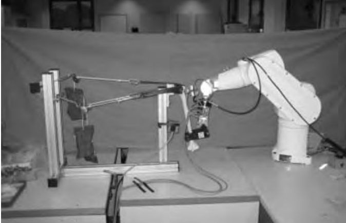
Fig. 2. Robot i elements que permeten la simulació dels exercicis de rehabilitació.
